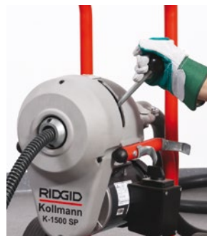
Wenn die Kupplung greift, rotiert die Spirale
