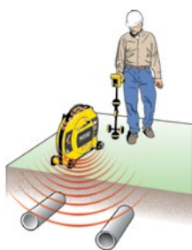
Induzieren eines Signals zur Lokalisierung von Versorgungsleitungen.
